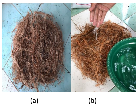
Gambar 2. (a)Proses penyusunan lembaran serabut kelapa ; (b) Proses penyiraman permukaan serabut kelapa
